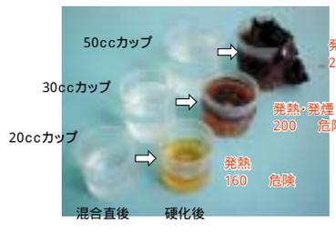
主剤と硬化剤の混合後は必ず5ミリ以下の厚みで固めて下さい。反応発熱の為、危険です。
